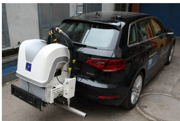
Abb. 1: Onroad-Messung der Abgasemissionen in Echtzeit, mit Hilfe eines modernsten, mobilen Abgasmesssystems (PEMS; engl.: P ortable E missions M easurement S ystem).
